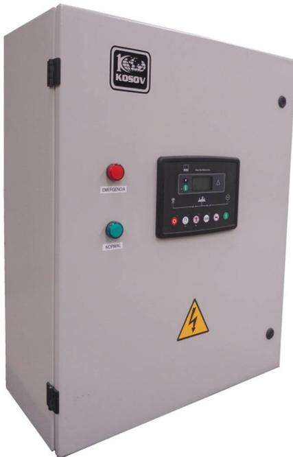
**FUNCIÓN DEL TABLERO:** Este tablero nos permite monitorear de forma continua las fases de la red comercial para que al detectar bajo voltaje o ausencia completa de electricidad, en una o en todas sus fases, mande una señal de arranque a la planta eléctrica, así mismo manda una señal al tablero de control y transferencia para haciéndose cargo la planta de emergencia de la carga conectada.
