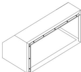
Este bafle acústico además de disminuir la emisión de ruido tiene la función de desviar el aire de la salida del radiador hacia el frente lo que nos permite
