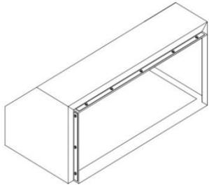
Este baffle acústico además de disminuir la emisión de ruido tiene la función de desviar el aire de la salida del radiador hacia el frente lo que nos permite disipar el aire caliente hacia el exterior del cuarto, esto con el fin de evitar recirculación de aire caliente, cuando el equipo con caseta se instala en interiores cerrados.
