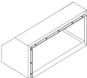
Este baffle acústico además de disminuir la emisión de ruido tiene la función de desviar el aire de la salida del radiador hacia el frente lo que nos permite disipar el aire caliente fuera del cuarto cuando el equipo con caseta se instala en interiores cerrados.
