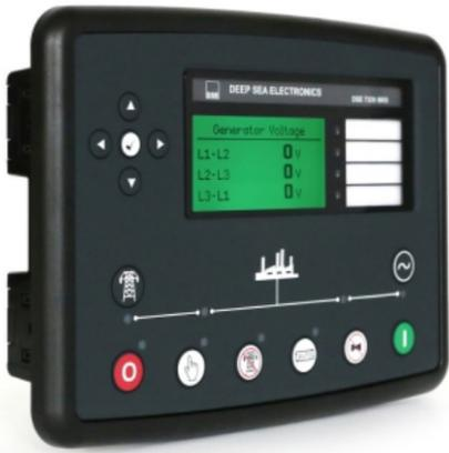
Modulo de control DSE 7320 MKII de arranque automático con falla de red comercial. Cuenta con display iluminado que muestra claramente el estado del motor en todo momento. Monitoreo de velocidad, frecuencia, voltaje, presión de aceite, temperatura de refrigerante y nivel de combustible. Muestra los estados de alarma y paro de motor.
